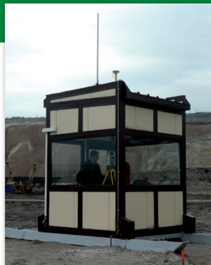
Kontener pomiarowy systemu ciągłego monitoringu deformacji wyrobisk górniczych w odkrywce Kopalni Węgla Brunatnego „Bełchatów”
